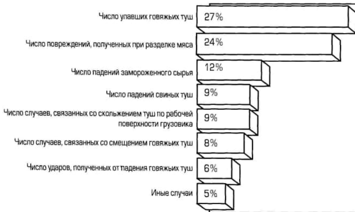
Схема N. Диаграмма Парето, на которой идентифицированы типы основных, наиболее часто возникавших несчастных случаев, произошедших в компании Tres Cruces за четырехнедельный период
